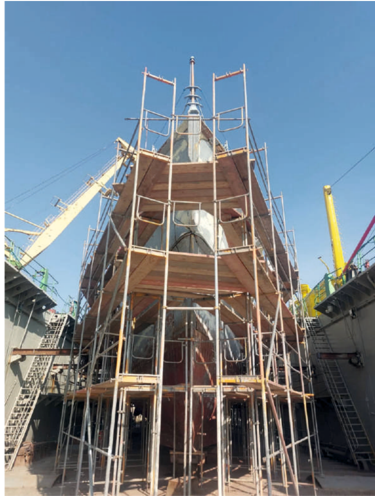
Laivapriekis dokinio remonto metu. E. Ubio nuotrauka.
